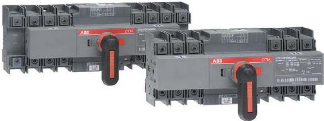
Теперь реверсивные рубильники с моторным приводом имеют расширенный типоряд токов от 40 до 2500 А и являются самыми компактными среди предлагаемых на рынке. Новые реверсивные рубильники имеют высокий уровень износостойкости и высокую стойкость к токам короткого замыкания. Моторные привода, защищенные встроенными тепловыми реле, переключают рубильники из положения 0 в I или из 0 в II за время 0,5 – 1с.
